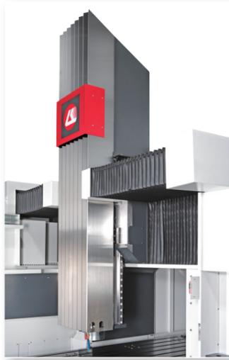
採用大功率內藏式電主軸設計強化剛性且主軸與伺服電機結合為一體，改進了直接傳動的噪音以及振動。
