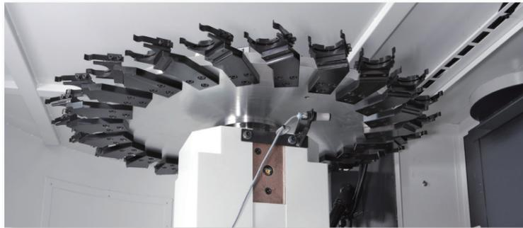
採用傘型式刀庫，有效的節省了佔地空間，並採用分割器快速傳動機構使動作更平穩、快速。
